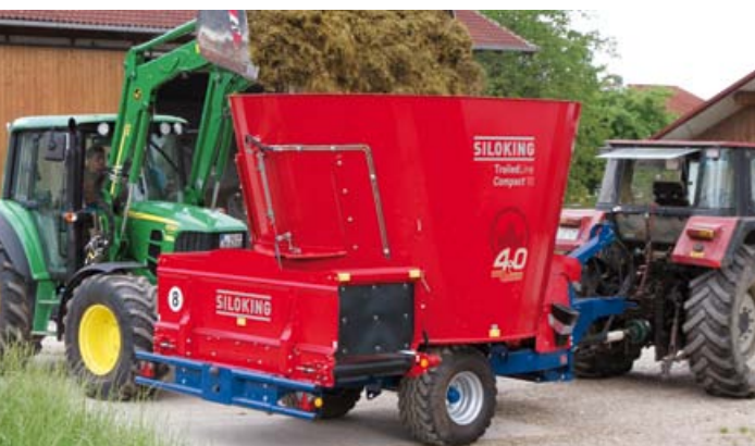
De robuuste onderrijbeveiliging met geïntegreerde verlichting zorgt voor veiligheid bij dag en nacht.
